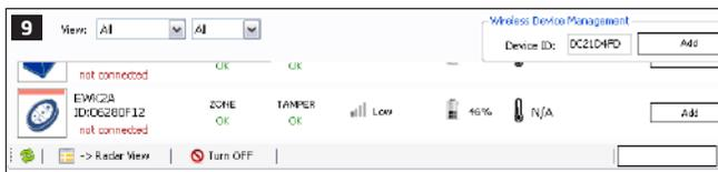
7. После программирования устройства в охранную систему, несколько раз нажмите какую-нибудь кнопку EWK2/EWK2A. При успешном программировании, рядом с иконкой EWK2/EWK2A появится сообщение **ПОДКЛЮЧЕНО**.
